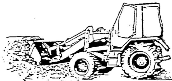
Per le operazioni di riempimento dai cumuli sciolti, disporre La benna in modo che il tagliente sia parallelo al suolo. Richiamare la benna anzitempo per evitare sprechi di potenza causati dallo strisciamento della sola parte posteriore della benna con mancata o scarsa penetrazione nel materiale
